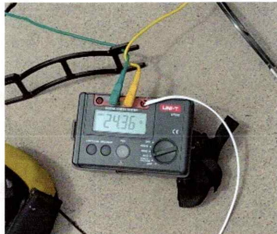
Medicion inicial tierra fisica 2
